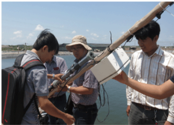
養殖場にセンサーネットワークを設置し、無線でデータを送信して水質をモニターする研究がベトナムで行われている（石橋教授提供）
